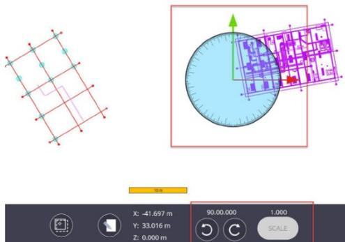
図面データの移動・回転・縮尺変更
