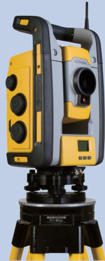
BIMデータを建築の施工現場や維持管理の業務で活用するには3D図面に対応した計測ソリューションが不可欠です。BIM専用トータルステーションTrimble RTSシリーズは、既に墨出し業務で定評のあるTrimble RPT600や3DレーザスキャナTrimble X7と同じFieldLinkを基幹ソフトとしており、施工から維持管理までデータの価値を循環させるエコシステムで建築の業務を支援します。
